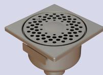
■ 150 x 150 mm ■ En acier inoxydable ■ Sortie verticale 50 mm ■ Inviolable ■ Orifices de 3 diamètres différents et bombage central ou avec ouverture annulaire de 6 mm ■ Garde d'eau conforme à la norme NF EN 1253
