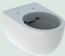
■ Cuvette Rimfree sans bride ■ Fixation facile grâce à la fixation murale Geberit type EFF2 pour WC ■ Type 1, volume total 6 L, selon EN 997 ■ Carénée ■ Arête supérieure de la cuvette rehaussée de 5 cm ■ Pour réservoirs à encastrer
