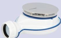
■ Haut Débit 33 L/mn ■ Clef spéciale double fonction garantissant : un couple de serrage optimal et servant de cache débris ■ Sortie horizontale : à visser à coller Ø 40 mm ■ Bonde avec clapet et contre-clapet Magnetech + garde d'eau 1 cm, système anti-remontées d'odeurs ■ Étanchéité instantanée garantie grâce aux joints co-injectés au corps de la bonde ■ Hygiène et facilité d'entretien grâce au siphon extractible
