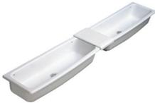
■ L 950 x l 330 x H 180 mm ■ Profondeur de cuve 16 cm, 26 kg ■ En céramique ■ Sans trop-plein ■ Fixation sur console de 250 mm (réf. D5706AC) ■ À équiper d'une bonde à grille (réf. D5870AA) ■ Possibilité d'installation en batterie avec couvre-joint (réf. P309001) ■ Compatible avec robinetterie Olyos Tempo (réf. D2546AA)
