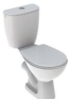
■ Sortie horizontale, avec réservoir attenant, avec abattant WC ■ Rinçage double touche ■ Avec bride, à fond creux ■ Alimentation latérale ■ Type 1, volume total 6 L, selon EN 997 ■ Abattant WC en duroplast ■ Non recouvrant
