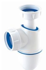
■ Ø 32 mm - BM211 ■ Astucieux, l'intégration du tube plongeur dans le corps sans écrou apporte un encombrement réduit ■ Réglage en hauteur supérieur à la normale : jusqu'à 100 mm ■ Plus aucune ré intervention sur chantier après intervention ■ Étanchéité parfaite grâce à la technologie bi-matière ■ Garde d'eau normalisée de 50 mm ■ Encombrement du culot : 94 mm
