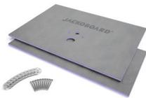
■ Dimensions des panneaux : 1300 x 600 mm et 1300 x 900 mm, épaisseur : 20 mm ■ 2 parties dont une prépercée ■ Suspendu en mousse dure de polystyrène extrudé incompressible ■ Compatible pour tous les WC suspendus ■ Directement carrelable grâce au revêtement spécial sur les deux faces ■ Matériau léger avec grande résistance en compression ■ Vis inox et rondelles autoforantes incluses
