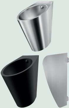
■ Urinoir individuel suspendu sans bride ■ Compatible avec tous les bâti-supports standards ■ Inox 304 bactériostatique, finition poli satiné, épaisseur inox : 1,2 mm ■ Arrivée d'eau par l'arrière (encastrée), évacuation d'eau horizontale encastrée ou apparente ■ Installation rapide et facile : montage par l'avant grâce à une platine de fixation en inox ■ Siphon 1"1/2, fixations ■ Marquage CE, conforme à la norme EN 13407 pour une chasse d'eau 2 L
