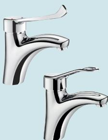
■ Mitigeur mécanique H 85 x L 135 avec sortie BIOSAFE hygiénique ■ Cartouche céramique Ø 40 ■ Butée de température maximale pré-réglée ■ Débit limité à 5 L/min à 3 bar ■ Manette ajourée, sans tirette ni vidage ■ Flexibles PEX F3/8", fixation renforcée par 2 tiges inox ■ Garantie 10 ans ■ Version EP : équilibrage de pression, sécurité anti-brûlure
