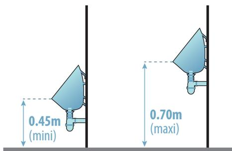
Les urinoirs en batterie doivent être disposés à des hauteurs différentes.
