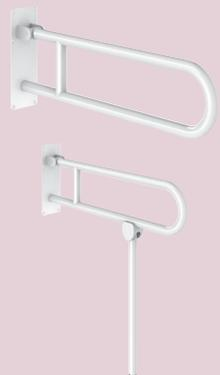
■ Rabattable Ø 32, pour personne à mobilité réduite (PMR) ■ Inox époxy blanc ■ Dimensions : 760 x 300 x 100 mm ■ Fixations visibles par platine inox 6 trous ■ CE - Garantie 10 ans
