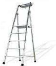
En Aluminium. Système de pliage. Sabot enveloppant. Montant tube rond surdimensionné Ø50mm. Liaison montant/marche indéformable anti-rotation. Charge maxi d'utilisation Testé à 350 Kg. Supprime les risques de basculement avant. Porte-outils et crochet porte-seau.
