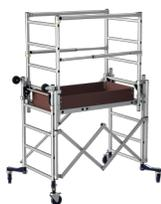
Véritable révolution dans le domaine des échaffaudages roulants, le Nano'Tower se monte en moins d'une minute et se charge dans le coffre d'un petit utilitaire. Il se monte et se démonte en toute sécurité (MDS) et se déplace facilement par une seule personne grâce son extrême légèreté et sa structure en aluminium (33 kg hors plinthes). Avec un seul produit, l'utilisateur peut travailler sur 4 niveaux de plancher (hauteur de travail maxi 3,00 m).
