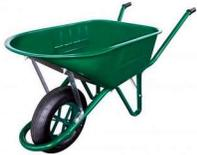
Coffre étroit largeur 60 cm, nez rond, peint, épaisseur 12/10ème. Coquilles de renfort de brancard galvanisées. Coussinets en fonte. Passe par les portes. Charge 250 kg. Roue Ø400 mm gonflable.
