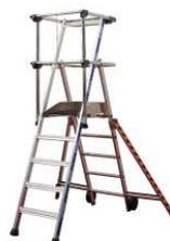
En Aluminium. Les stabilisateurs s'adaptent individuellement aux configurations des sols. Porte-outils intégré sans aspérité. Charge utile. Espacement entre marches 250mm. Liaison sertie montant/marches. Marche striée 80mm. Stabilisateurs repliés dans les passages étroits. Sécurité latérales, avant et arrière. Fermeture du garde-corps. Transport et passage de porte facilité.
