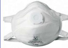
Avec soupape d'expiration. Média filtrant en polypropylène (MB) électrostatique. Couche extérieure en polypropylène (SMS). Couche intérieure en polyester. Pince-nez en aluminium. Bandes élastiques gainées, avec boucles de serrage. Joint facial d'étanchéité en mousse de
