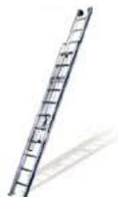
En Aluminium. Basculeur incassable alu extrudé. Rappel automatique. Entraxe 250mm. Echelons 30x30mm. Orienté, le pied repose à plat. Roulettes de développement Ø125mm. Echelons dans le prolongement : "marche virtuelle" Réduit l'effort de montée. Patins articulés toujours en bonne position 100% de contact au sol. Appui du genou. Sécurité renforcée possibilité d'ancrage au sol.
