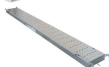
En acier galvanisé. Crochets universels. Tirettes anti soulèvements. Ferrures aux extrémités pour une meilleure rigidité. 2 poignées de manutention. Encoches pour emboîtements des plinthes.
