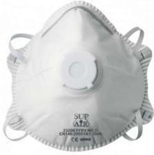
Soupape d'expiration. Média filtrant en polypropylène (MB) électrostatique. Couche extérieure et intérieure en polypropylène (SMS). Élastique en gomme synthétique sans latex. Pince-nez en aluminium. Coussinet nasal en mousse de polyéthylène.
