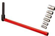
Pour le montage et le démontage des robinets et mitigeurs à fixation avec écrou. Bras creux de 25 cm de longueur. Embout creux pour écrous hexagonaux de 13 mm.
