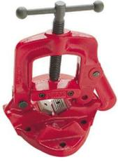
*Vis à filet trapézoïdal. Étau en fonte malléable à haute limite élastique. Arcade réversible permettant d'obtenir la meilleure position de travail sur établi tripode ou table. Mors en acier traité. Vê de soutien.*
