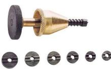
Appareil à fraiser les sièges de robinets. Ressort pour maintenir la fraise au contact du siège de robinet. Fraise taillée en bout, vissée sur le porte-fraise. Taraudage M7. Cône assurant l'adaptation sur la tête du robinet.
