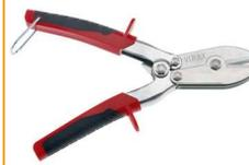
La pénétration des couteaux entre eux forme sur le pourtour du tuyau une ondulation qui diminue le diamètre et permet l'emboîtement aisé et régulier de tous les tuyaux (de fumée, d'évacuation de gaz, de ventilation, d'aspiration de poussières, de descente d'eau...). Un ajustage précis est obtenu en variant la pression sur les poignées. Poignées isolantes. Couteaux et axes cémentés.
