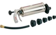
Idéal pour les bouchons éloignés du siphon. Il utilise l'énergie cinétique accumulée dans le réservoir cylindrique pour expulser les bouchons de graisse, savon, lessive, cheveux, papier, chiffon... Permet le débouchage des canalisations d'un Ø intérieur de 100mm maxi dans le domaine du sanitaire (lavabos, éviers, urinoirs, baignoires...) et WC. Manomètre intégré pour mesurer la pression à exercer.
