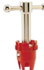
Complément indispensable de nos clés lavabos pour le maintien de la bonde pendant le serrage ou le desserrage de l'écrou. Clé : taraudages M8 et M10 pour montage de goujons mixtes.
