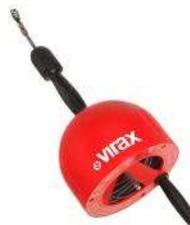
Déboucheur manuel à câble pour canalisations Ø25-50mm, longueur de câble maximale de 7,5m. Vrille articulée pour un passage facilité dans les coudés. Très résistant, en acier spécial traité haute qualité, avec âme acier. Maniable et léger, seulement 2,7kg avec câble. Utilisation manuelle ou avec une perceuse électrique (non fournie).
