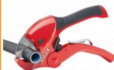
Matière coupée : PVC, PP, PE, PER, PEX, ABS, PEHD, CPVC, PPR, PB. La forme du bras supérieur permet un guidage parfait lors de la coupe. La lame en « V » permet une coupe facile et perpendiculaire. Mécanisme à cliquet breveté : coupe rapide, peu d'efforts de coupe, pas de retour de la lame lors de la coupe.
