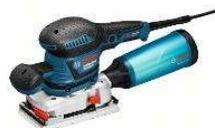
Taux de vibrations le plus faible de sa catégorie (< 2,5 m/s<sup>2</sup>) grâce au carter moteur découpé. Répartition homogène de la pression d'appui pour une qualité de surface parfaite. Maintien parfait du papier abrasif même non auto-agrippant grâce au système de serrage innovant.
