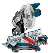
*Tête inclinable à gauche à 47°. Laser intégré Réglage des coupes d'onglets. Entretoises intégrées. Les entretoises à l'avant permettent une plus grande capacité de coupe verticale. Les entretoises à l'arrière permettent une plus grande capacité de coupe horizontale.*
