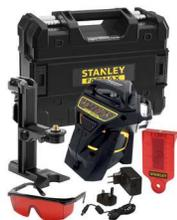
Projette 3 lignes pour 360°. Précision de la ligne : 3mm@10m. Diode Laser pulsée pour une très haute visibilité (635-645 nm). Plage d'utilisation : 20 m selon la luminosité-50 m avec la cellule. Batteries Li ion pour utilisation 24H – Fonctionne également sur secteur. Etanchéité : Norme IP 54 – Classe 2. Nouveau design avec un très faible encombrement pour travailler au plus près du mur (Ex : réalisation d'un doublage). Livré avec Laser – Cible – Chargeur – Batterie Li ion – Lunette
