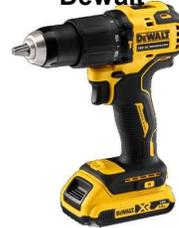
18V. Capacité mandrin 1,5-13mm. Ø perçage bois/béton/métal : 30/13/13mm. 2 vitesses, 15 positions. 2 batteries 3Ah Li-ion. Brushless. Coffret Tstak.
