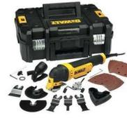
*300w avec 32 accessoires. Rapidité et facilité de changement d'accessoires sans outil ni clé. Prise en main étudiée pour délivrer le moins de vibration possible. Interrupteur actionnable en 2 points, vitesse variable suivant la pression exercée (0-22000 osc.min). Coffret Tstak*
