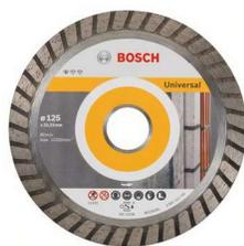
Disque à tronçonner Diamanté STANDARD FOR UNIVERSAL TURBO, hauteur de segment 10 mm, idéal pour le béton, béton cellulaire/thermopierre, tuile, maçonnerie. Alésage 22,23 mm.
