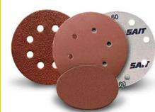
Disques auto-agrippants en papier abrasif sans trou. Papier abrasif au corindon, double résine, support D, structure ouverte. Préparation de surfaces métalliques avant peinture ou émaillage. Applications Carrosserie : Enduits, Fonds Applications Bois : Bois brut
