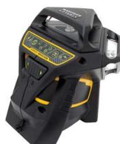
Nouvelle technologie de faisceaux verts, 3 lignes pour 360° de couverture, Choix sélectif des faisceaux (horizontal, vertical...), Diode Laser pulsée pour une très haute visibilité : 515-530 nm- 35 m de rayon (50 m avec cellule), une précision de 3mm/10m, un double filetage 1/4" et 3/8" pour trépied-Laser – Cible – Chargeur – Batterie Li ion – Lunettes – Malette de
