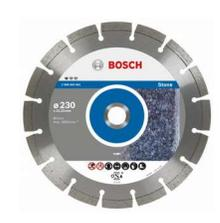
Disque à tronçonner Diamanté PROFESSIONAL FOR STONE, hauteur de segment 10 mm, idéal pour le granite et pierre naturelle. Alésage 22,23 mm.
