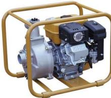
Auto-amorçante, essence motorisation ROBIN SUBARU EX, eaux chargées 520L/min - 31,2m3/h, 3,2 bars. Ø du raccord de refoulement et d'aspiration : 50mm
