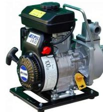
Auto-amorçante, essence motorisation Worms, eaux claires 133L/min - 8m3/h, 2 bars. Ø du raccord de refoulement et d'aspiration : 25mm
