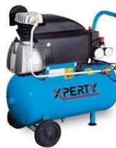
Réservoir : 24 litres. Puissance moteur : 2 CV – 1,5 kW. Alimentation : 230 V mono. Volume engendré : 14 m<sup>3</sup>/h. Pression max de service : 8 bar. Coaxial lubrifié. Pour gonfler, agraffer, souffler, pulvériser, peindre, clouer
