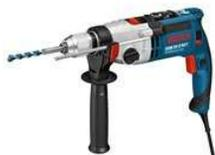
1300W. Mandrin automatique Ø 13 mm. Couple nominal 40 /14,5. Poignée ergonomique Soft Grip. Butée de profondeur. Ø maxi acier 16 mm, bois 40 mm, maçonnerie 24 mm, Béton 22/13 mm. 2 vitesses avec présélection 0-900/ 0-3 000 tr/min. Fréquence de frappe 0-15 300 / 51 000 cps/min. Débrayage de sécurité. Poids 2,8 kg.
