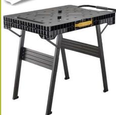
Large surface de travail : 85x60cm. Les pieds se replient/déplient très rapidement et facilement en 5 secondes. Poignée télescopique pour un transport facile + pouvant servir de support pour les longues pièces. Poids de charge répartie 250 kg. Pieds métalliques. Compatible avec utilisation verticale et horizontale de tout type de serre-joints.
