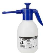
Tête de pulvérisateur avec buse plastique réglable et obturable. Recommandé pour la désinfection, le lavage de machines et de véhicules ainsi que pour la pulvérisation d'huile de coffrage, dans la mesure où le produit utilisé est compatible avec les joints. N'est pas utilisable avec l'acétone, le glycol, les solvants, les nettoyeurs de frein et les acides comme par exemple: l'acide formique et l'acide acétique.
