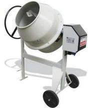
1 sac de 25 kg - Capacité de cuve 160 L - Capacité de malaxage 140 L - Roues diam. 250 mm - couronne fonte . Puissance absorbée du moteur 800 w - Double isolation - Classe II - Transmission courroie crantée.
