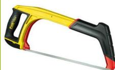
Poignée revolver et repose doigt bimatière - 2 angles de coupe possibles : 45° (coupe à ras) et 90° (coupe standard) - Démontable en 5 configurations d'archer - Jusqu'à 120 mm de capacité de coupe -
