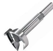
La tête de la mèche réduit les efforts de coupe et permet d'augmenter la vitesse de coupe. Rainures asymétriques pour casser les copeaux. Longueur 90mm
